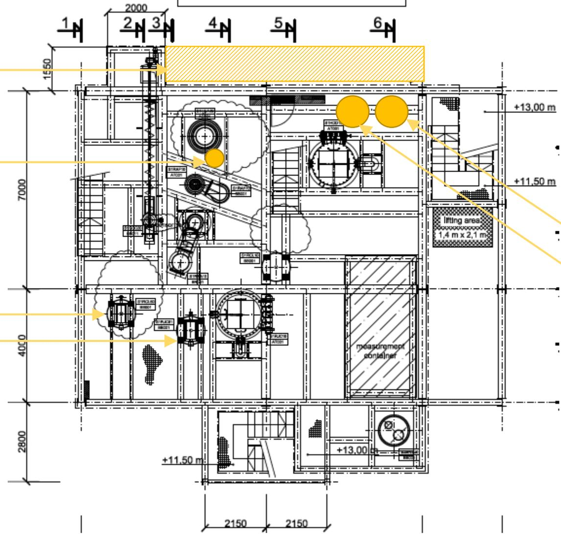
Emplacement pressenti d'une ou deux trémies pour injection de charbon actif et de  $\text{NaHCO}_3$  sur la ligne fumée
