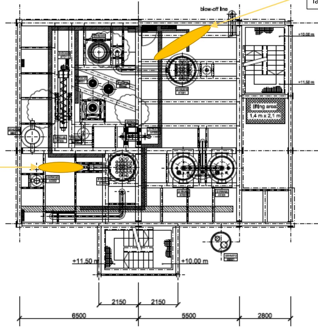
Possibles travaux de tuyauterie pour l'injection de CaCO3 et de charbon actif sur la ligne syngaz
